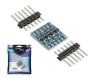
Módulo com função bidirecional que reduz de 5V para 3,3V e aumenta de 3.3V para 5V, possui duas entradas e duas saídas em cada lado, compatível também com dispositivos de 2,8V e 1,8V.
